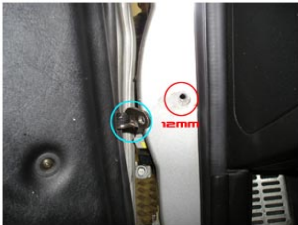
2. 안쪽 작은 경첩을 탈거합니다. Take off small hinge.
