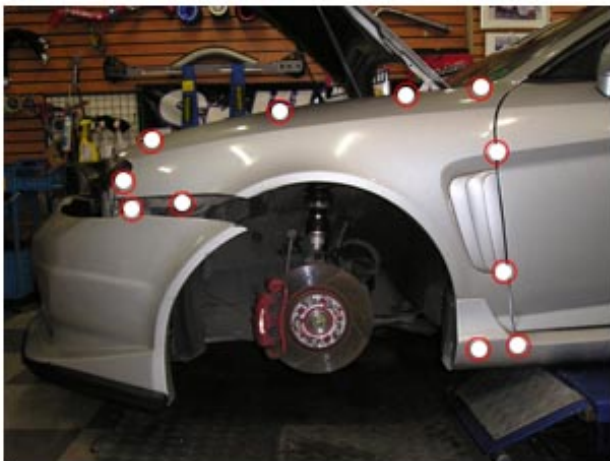
1. 웬더를 탈거합니다.(11개의 볼트 탈거) Take off fender. (11 Bolts)
