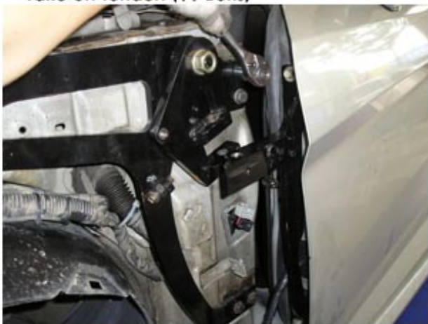
4. 2파트로 나눈 결형제품을 각각 문과 웬더에 장착합니다. Separate the two parts of the hinge by taking out the pin. Install the two parts separately on the door and car frame.
