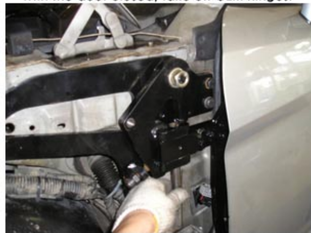
6. 2파트로 장착된 제품을 하나로 조립할때, 굵은 핀을 아래에서 위로 결합하고, 마무리로 클립을 끼워넣습니다. Connect the two parts of the hinge by inserting the pin from the bottom, and inserting the two clips at the top and bottom of the pin.
