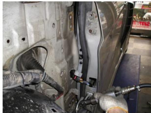
3. 문과 웬더의 경첩을 탈거합니다. With the door closed, take off OEM hinges.
