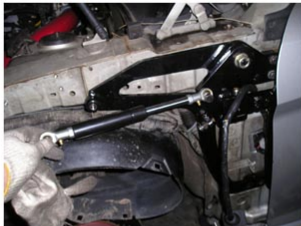
8. 쇼바장착시 쇼바의 방향을 주의깊게 살핀후 먼저 한쪽부분을 장착합니다. Orient the strut so that the body of the strut is towards the car and the rod is towards the door.
